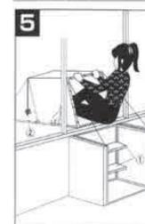
1. 取付金具に設けられているステップを手前に倒す。①
