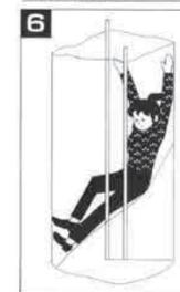
1. 降下中、両手を上上げて右ひざを内側に心持ち曲げ、背中および腕部で滑り降りる。
