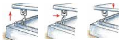
上蓋を持ち上げてもロック が掛かり蓋が開きません。 ロックの外し方 レバーを矢印の方向に押すと フックから外れてロック解除に なり蓋が開きます。 ロックの掛け方 上蓋を閉めると自動的に レバーがフックに掛かり ロックします。
