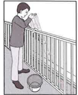
下階に人がいないことを確認し、オリロープを順次下ろす。
